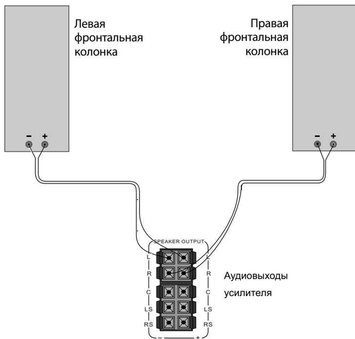
**Примечание.** Проверьте соответствие полярности подключения и отсутствие контакта оголенных проводов между собой и с металлическими частями аппаратуры.
