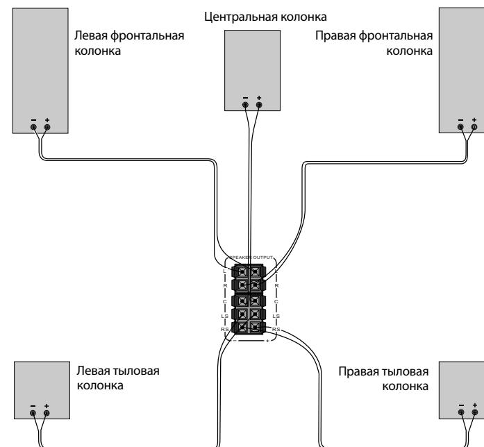
**Примечание.** Проверьте соответствие полярности подключения и отсутствие контакта оголенных проводов между собой и с металлическими частями аппарата.
